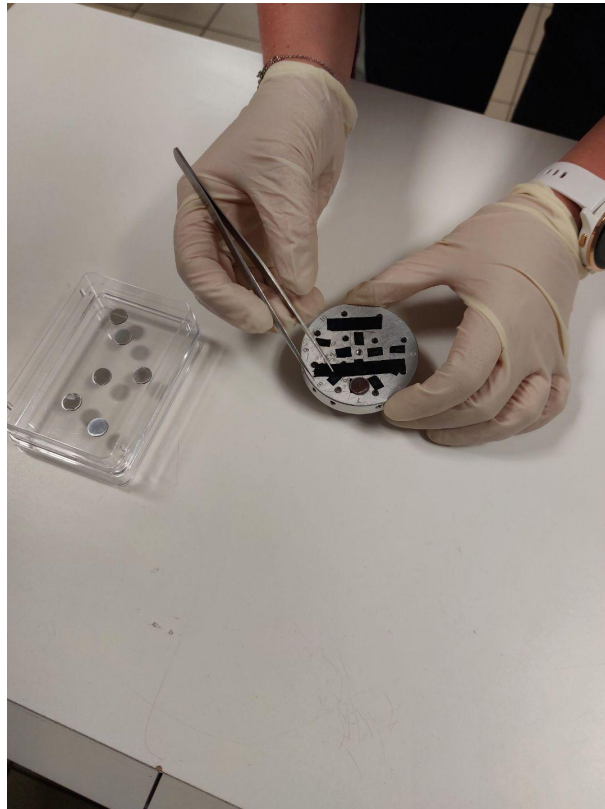
FIG 24 : Mise en place des échantillons sur le support du microscope électronique à balayage à l'aide d'une pince
