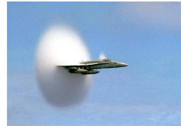
Figure 3.6 : Cône de Mach créé par un avion en vitesse supersonique.
