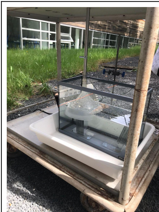
Electrolyseur : électrodes sur leurs supports, entonnoir de récupération du dihydrogène, et électrolyte.
