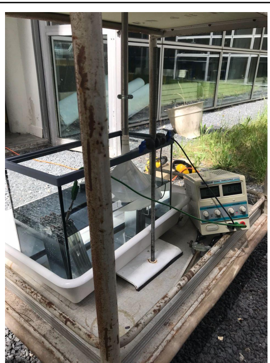
Installation de l'électrolyseur avec l'alimentation.
