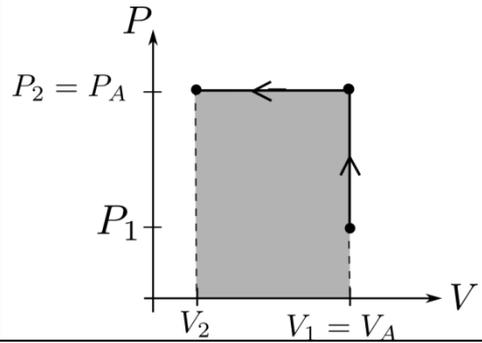
$$1 \rightarrow A \text{ isochore : } \frac{P_1}{T_1} = \frac{P_A}{T_A} \Leftrightarrow T_A = T_1 \frac{P_2}{P_1}.$$
