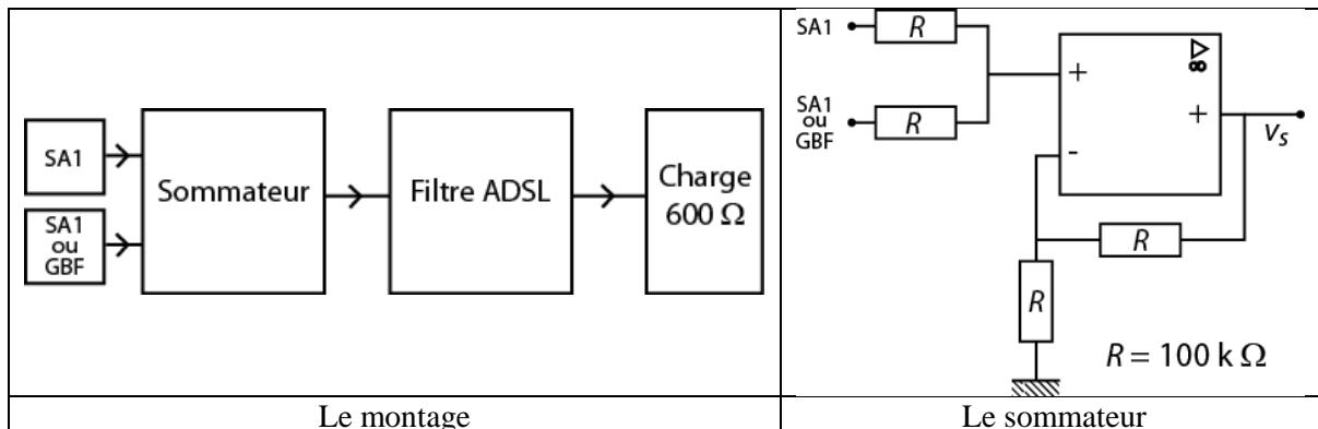
Le sommateur en amont du filtre est destiné à superposer un signal sinusoïdal de fréquence téléphonique fourni par la sortie analogique SA1 de la rosace d'acquisition Eurosmart à un autre signal sinusoïdal de fréquence ADSL délivré par un GBF.
