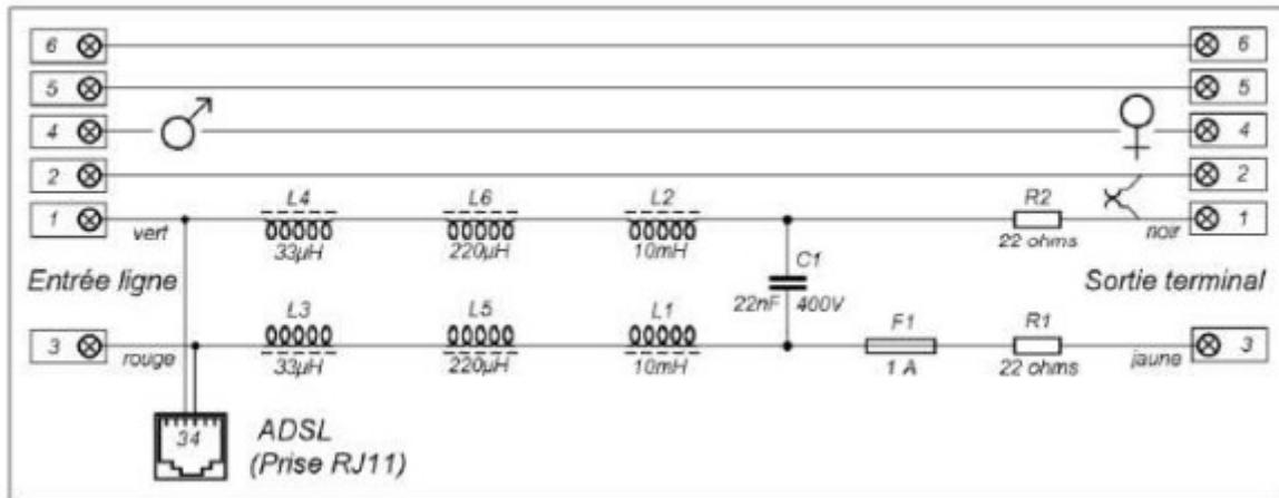
Les contacts mâles 1 et 3 sont reliés à la prise murale. Le signal reçu est envoyé directement au modem via la prise RJ11. Le modem extraîtra les données numériques.
