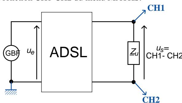
Relever sur un nombre de décades suffisant les amplitudes crête à crête de la tension en sortie du filtre.
