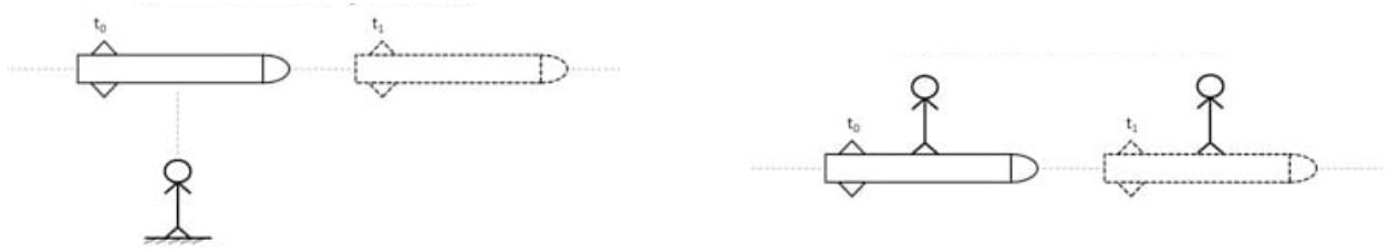
FIGURE 1.1 – Description Eulérienne (à gauche) et Lagrangienne (à droite) du mouvement
