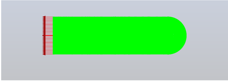
FIGURE 2.12 – Condition de sortie (Pressure Outlet) appliquée au petit bord
