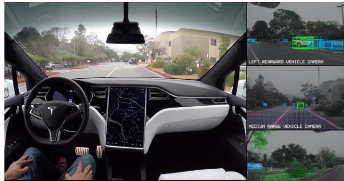
Figure 2 : Modélisation de la perception dans une Tesla autonome
