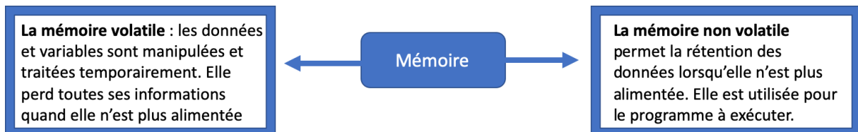
Figure 10 : Schéma présentant les différents types de mémoire des microcontrôleurs [15]
