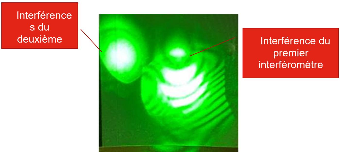
Figure 40 : Interférence obtenue avec le montage avec les deux interféromètres de Michelson
