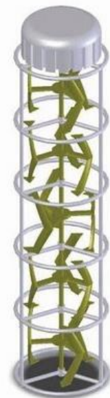
Figure 18 : Assemblage de turbines verticales
