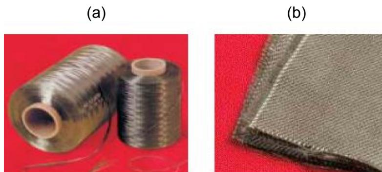
Fig. – (a) Bobine de fibres de basalte – (b) Tissus de basalte [CAR]
