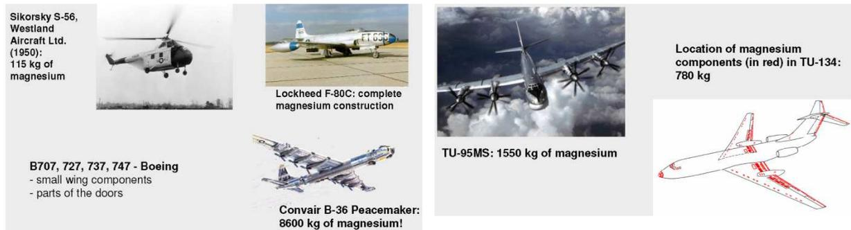
Fig. 18 – Exemples d'utilisation des alliages de magnésium [PAS]
