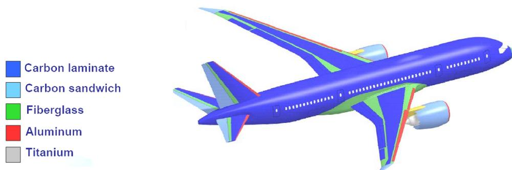
Fig. – Répartition des composites à fibres de carbone dans le Boeing 787 Dreamliner [BOE]
