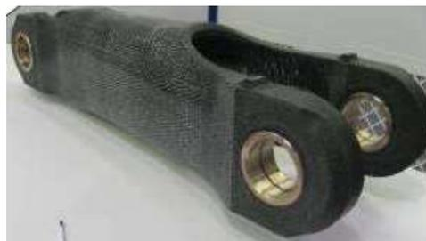
Fig. 10 – Bielle de train d'atterrissage réalisée en matériau composite
