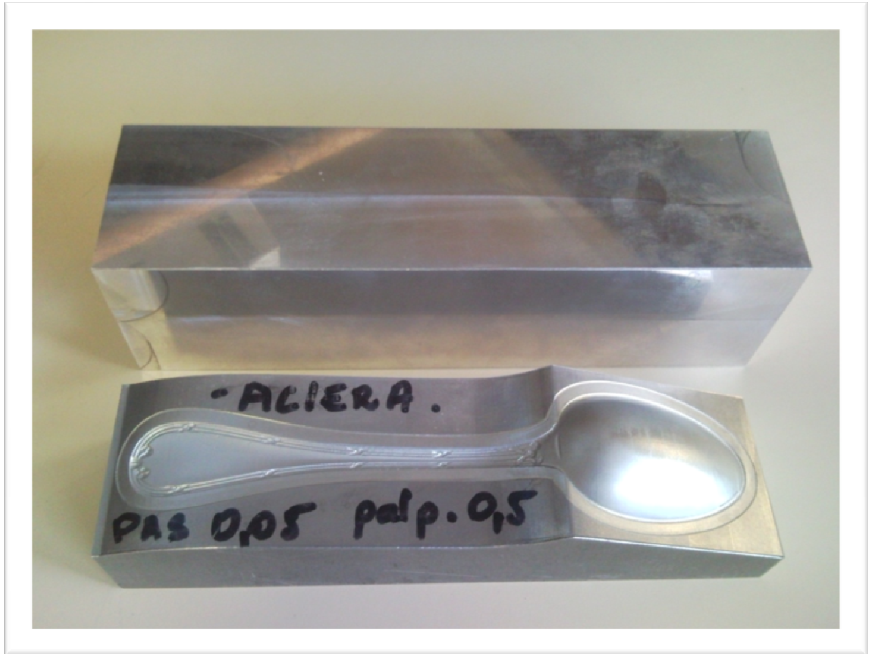
Exemple d'une matrice cuillère [Bloc acier initial et final]
