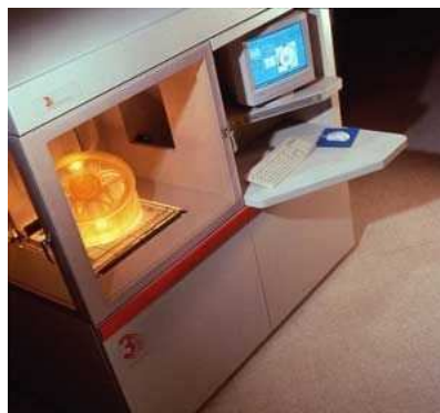
Figure 6 : Machine appliquant la technique de polymérisation de résine
