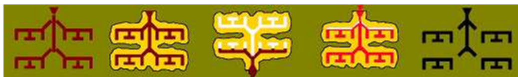
Figure 2 : Démarche pour le moulage à cire perdue
