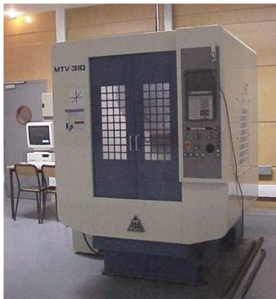
Figure 10 : Machine réalisant l'UGV
