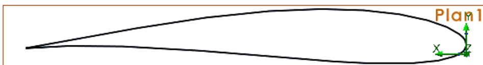
Figure 19 : Section d'une pale d'éolienne
