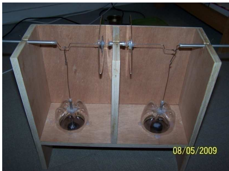
Figure 12: Le moteur Alpha avec l'axe rééquilibré.
