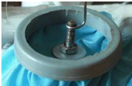
Figure 4 Tige du piston sur la vis
