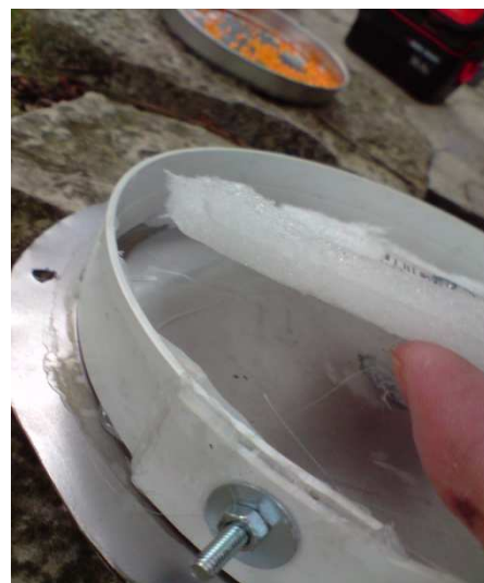
Figure 3 La plaque, l'étancheur et le piston.
