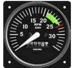
Il existe trois types principalement de tachymètres, en effet ce sont les plus efficaces. Le premier type est le tachymètre mécanique, il est soit à force centrifugée, c'est-à-dire que la force centrifuge, appuie sur un ressort dont l'écrasement est fonction de la vitesse de rotation.
