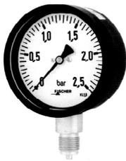
Le manomètre de Bourdon mesure une pression effective, car la pression de référence est la pression extérieure, c'est-à-dire la pression atmosphérique. De manière générale, le tube est rempli d'un liquide non corrosif tel que l'huile, car la détérioration du tube pourrait causer la raideur
