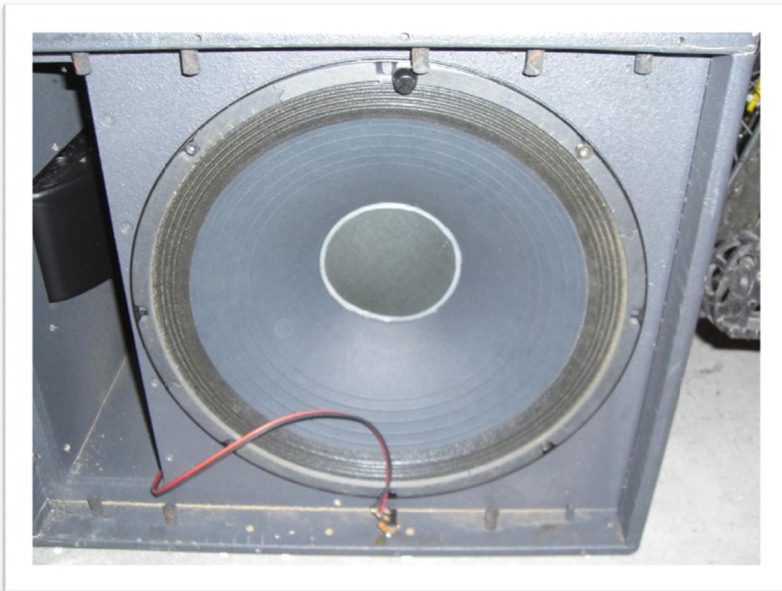
Le choix a été de ne pas fixer le châssis sur le caisson et de le laisser libre comme on le voit ci-dessus. Cela permettra ultérieurement d'y injecter un filtre qui pourra distribuer les fréquences de telle façon que ce caisson ne reçoive que les basses fréquences (50-200Hz).
