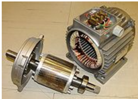
FIG. 1.1: Un moteur triphasé, Rotor à gauche, Stator à droite
