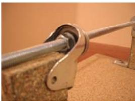
Nous nous sommes rapidement réorientés sur une seconde version avec cette fois-ci avec des roulements à bille de qualité supérieure. Nous avons également changé le maintien de l'axe sur les supports en raison des nouveaux roulements.
