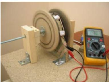
Puis nous avons fixé les aimants sur les disques, les disques sur l'axe et fait un premier essai !
