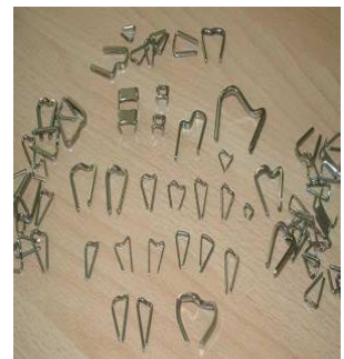
7 : Différentes agrafes d'ostéosynthèse en Nickel-Titane
