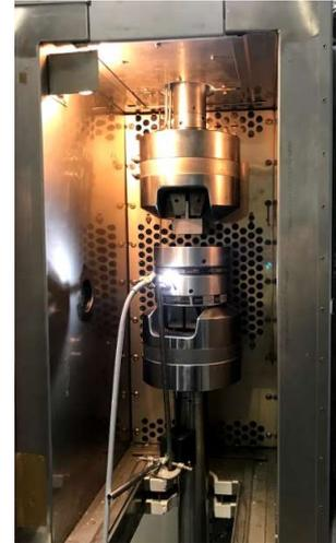
*Figure 2: Machine d'essai mécanique de compression*
