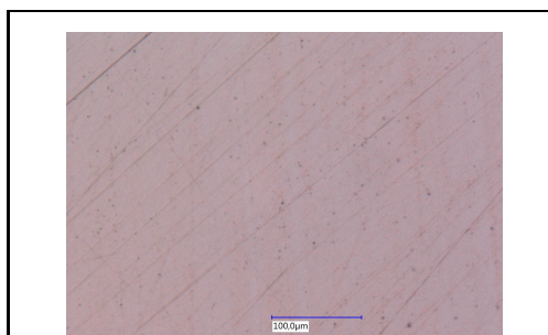
Image 25: Photo de la face Z avec rayures du polissage de notre échantillon
