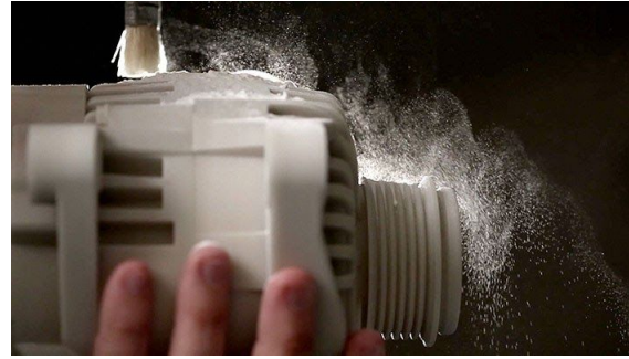
Image 8: Photo d'une pièce de moteur fabriquée par projection de poudre
