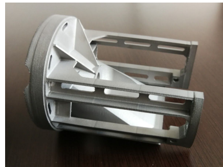
Image 2: Photo d'un piston fabriqué par Fusion Laser Sélective
