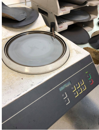
Image 17: Photo de la polisseuse utilisée avec un papier polisseur de 600 grains
