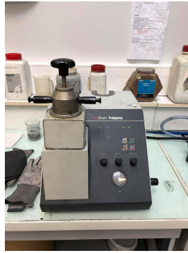
Image 16: Photo de la PEDROPRESS - STRUERS utilisée pour l'enrobage des échantillons
