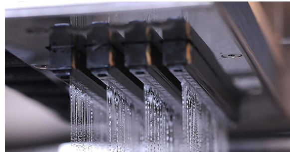
Image 14 : Photo du liant coulant sur la poudre pour la fabrication de la pièce
