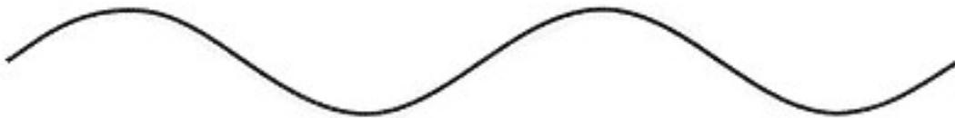
Le signal de la porteuse  $v_p(t)$  est quant à elle de fréquence élevée. Ainsi, elle sera facilement diffusable . Son allure est la suivante :
