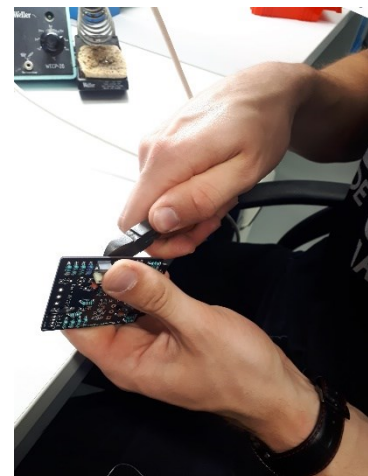
Coupure des pates des composants
