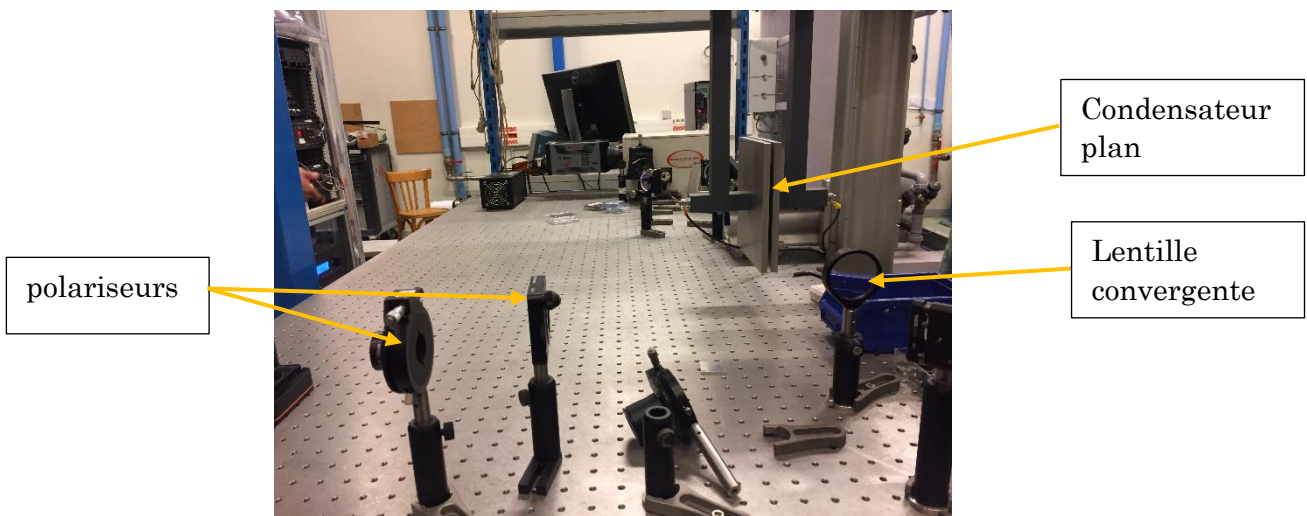
Illustration 7 : première partie du montage expérimental
