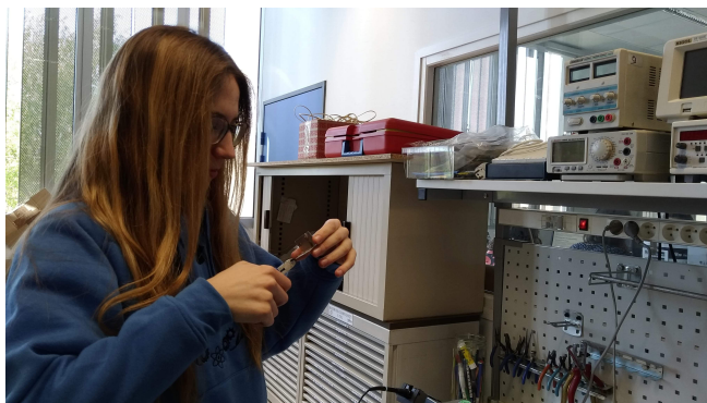
FIGURE 3.10 – Catheline, faisant des trous dans la structure de mica pour y insérer le fil résistif
