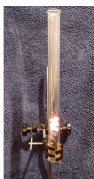
FIGURE 3.5 – Plaçage du tube dans un collier de serrage [10]
