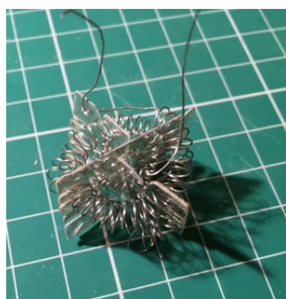
FIGURE 3.2 – Enroulement du fil pour formation d'une bobine [10]
