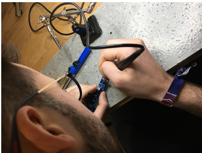
Illustration 7: Remise en place du capteur
