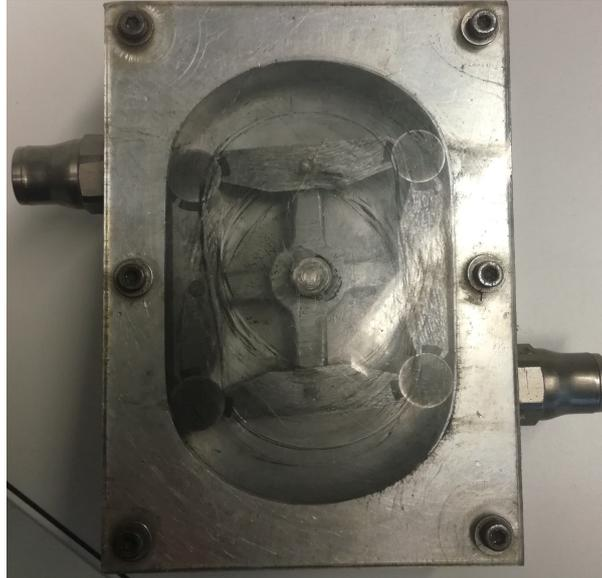
FIGURE 2.1 – Prototype de moteur en losange réalisé par M.Meyer
