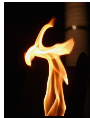
Figure 4 : flamme de pré-mélange en combustion incomplète
