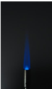
Figure 3 : flamme de pré-mélange en combustion complète
