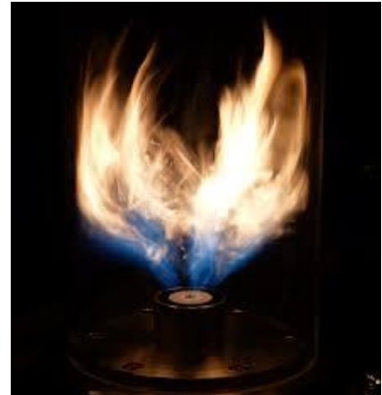
Figure 5 : Illustrations représentant un swirler axial et une flamme swirlée
