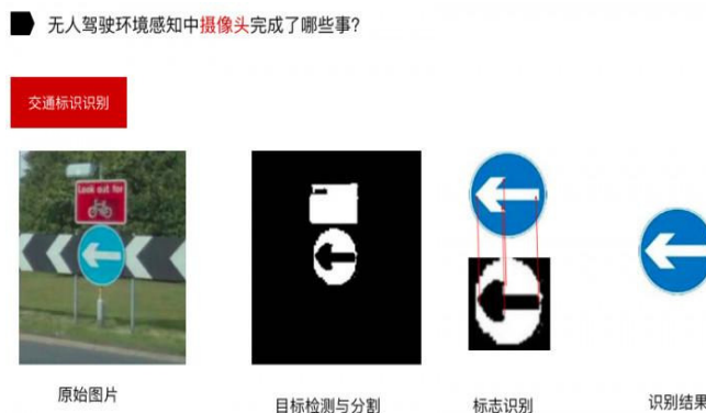
FIGURE 3.10 – La figure ci-dessus illustre le processus d'identification des panneaux de signalisation.
