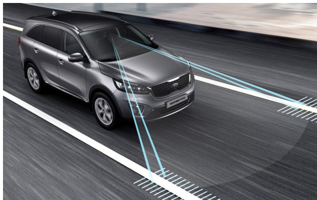
FIGURE 1.3 – Détection de ligne blanche
