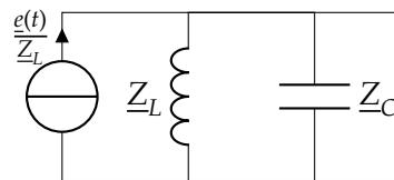
On calcule l'impédance équivalente à  $\underline{Z}_C$  et  $\underline{Z}_L$ , associées en parallèle :  $\underline{Z}_{eq} = \frac{\underline{Z}_L \underline{Z}_C}{\underline{Z}_L + \underline{Z}_C}$ .
