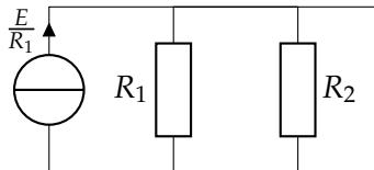
On calcule la résistance équivalente à  $R_1$  et  $R_2$ , associées en parallèle :  $R_{eq} = \frac{R_1 R_2}{R_1 + R_2}$ .
