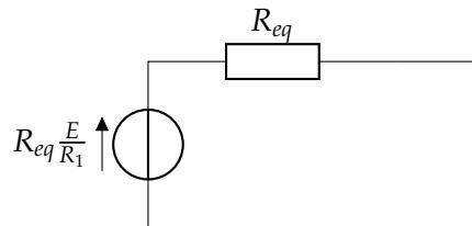
On trouve  $E_{th} = R_{eq} \frac{E}{R_1} = \frac{R_2}{R_1 + R_2} E$  et  $R_{th} = R_{eq} = \frac{R_1 R_2}{R_1 + R_2}$ .
