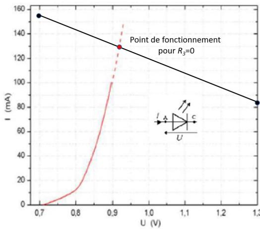
Le point de fonctionnement est l'intersection de la droite avec la caractéristique de la DEL. On trouve environ  $U = 0,92$  V et  $i = 130$  mA.
