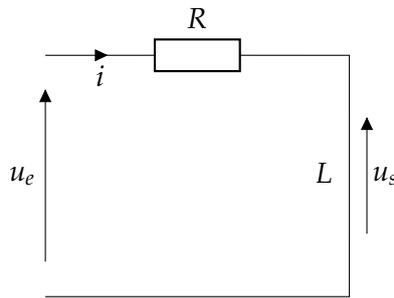
• On se place en hautes fréquences, la bobine est équivalente à un interrupteur ouvert et, comme  $i = 0$ , on obtient  $u_s = u_e$ .
