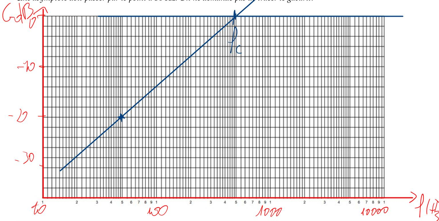
On obtient la fréquence de coupure à l'intersection des asymptotes pour ce filtre d'ordre 1 :  $f_c = 500$  Hz.
