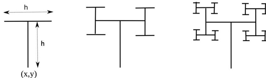
On dispose d'une procédure `trace-T` ( $\underline{E} t, x, y, dir : \text{entier}$ ) qui trace un T de taille  $t$  (en pixels) dont la verticale est égale à l'horizontale, à partir du point de coordonnées  $(x, y)$  (à la base du T) et dans la direction  $dir$  ( $= -1$  si l'arbre est dirigé vers le haut et  $= 1$  si vers le bas). On considère que l'origine des coordonnées est en haut à gauche de l'écran.
