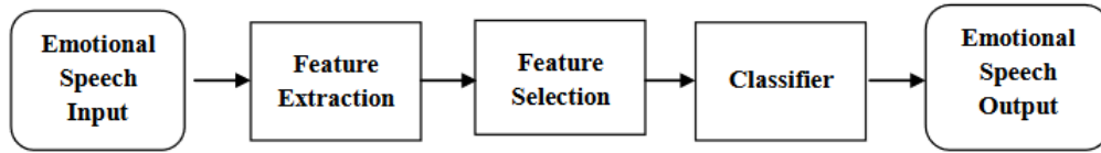
Fig. 1. Chaîne de traitement de la Speech Emotion Recognition (SER), d'après [3]
