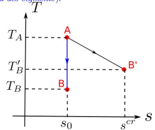
2c) Déterminer l'énergie dissipée  $\varepsilon$  à la traversée de la tuyère.
