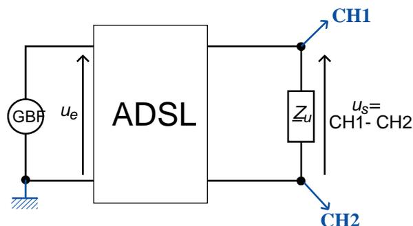
Relever sur un nombre de décades suffisant les amplitudes crête à crête de la tension en sortie du filtre.
