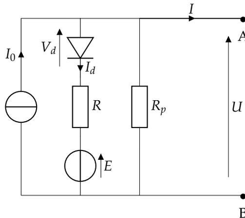
Le panneau photovoltaïque présente deux régimes de fonctionnement suivant l'état de la diode. Si la diode est bloquante, il fonctionne comme une source de courant et si la diode est passante, il fonctionne comme une source de tension.
