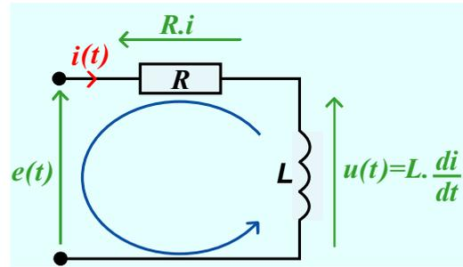
Cette excitation modélise l'ouverture d'un interrupteur, et son remplacement par un fil. A partir de la date  $t = 0$ , plus aucune énergie n'est apportée au réseau.
