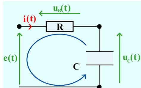
$e$  est un échelon de tension. Un échelon de tension modélise la fermeture d'un interrupteur.
