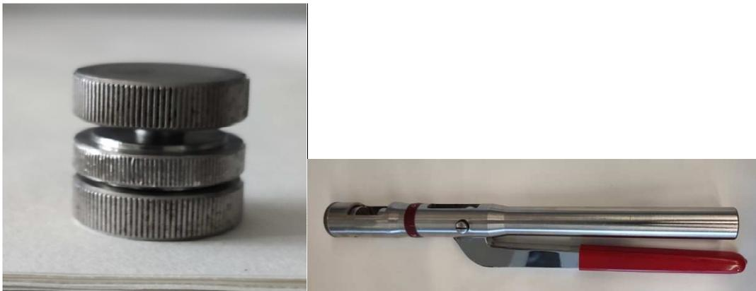
Figure 3 Moule à pastiller et presse pour préparer les pastilles de KBr
