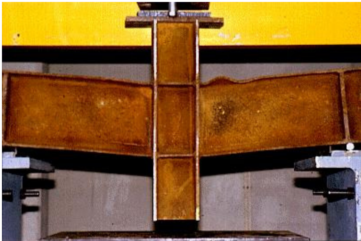
Flambement local du voile de la poutre
