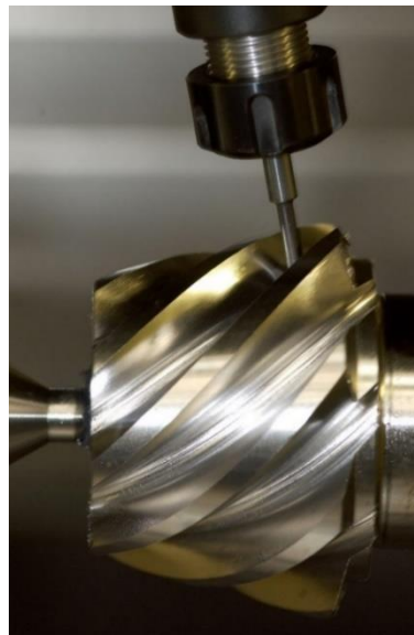
figure 40 : Taillage 2T par fraisage 5 axes
