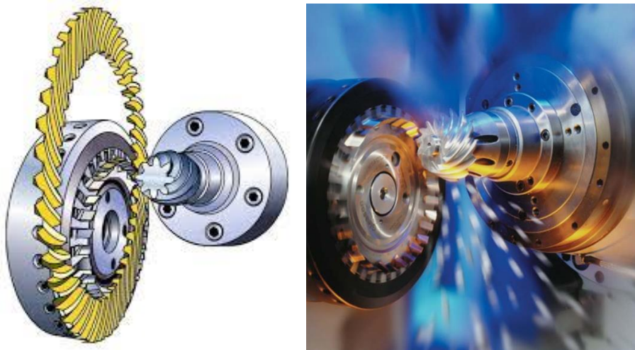
figure 37 : Taillage spiro-conique : en jaune la roue plate virtuelle. Le profil de la fraise correspond à une dent de cette roue (source Gleason).
