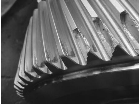
figure 100 : Rupture de dents causée par un désalignement des axes (source L. O. Amaral Affonso)
