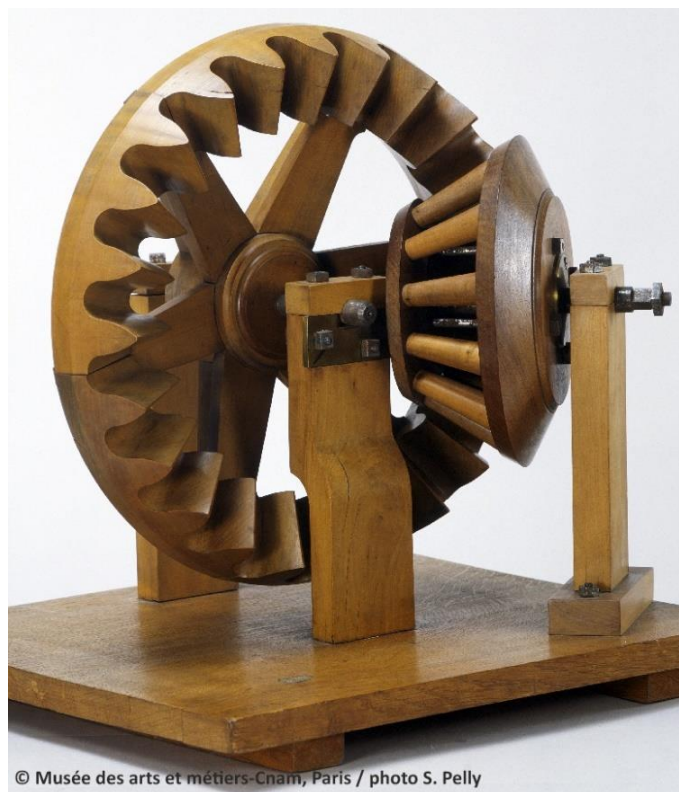
figure 7 : Maquette d'engrenage construite par Th. Olivier en 1845 (musée du CNAM Paris). Le pignon (à droite) est encore une roue à lanterne alors que la roue (au fond) adopte un profil proche de la développante de cercle actuelle.
