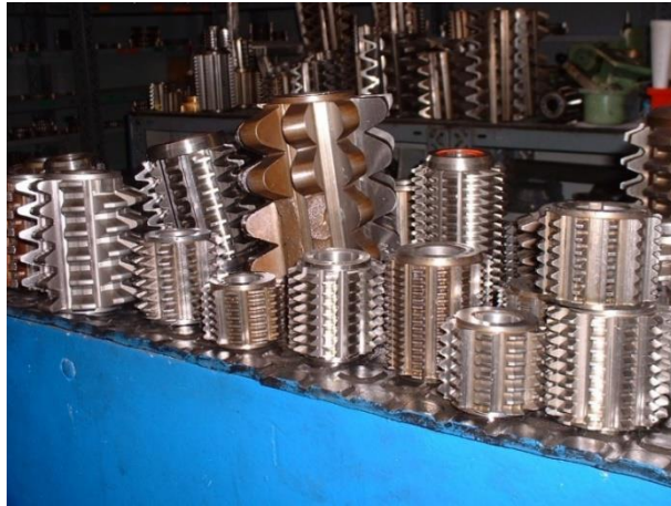
figure 39 : Magasin de fraises mères de différents modules
