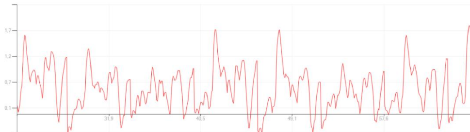
figure 119 : Courbe d'écart de transmission : abscisse = développement de l'engrènement (en mm) ; ordonnée = écart d'engrènement (en \mu\text{m} )
