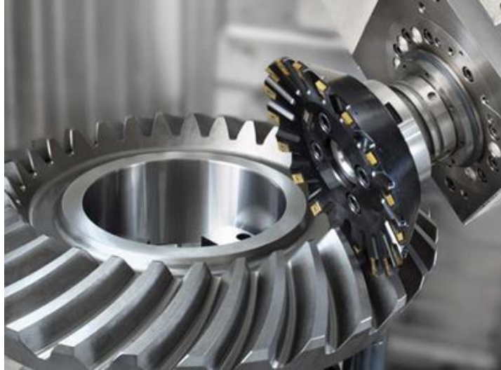
figure 41 : Taillage 3T par fraisage 5 axes (source Sandvik)
