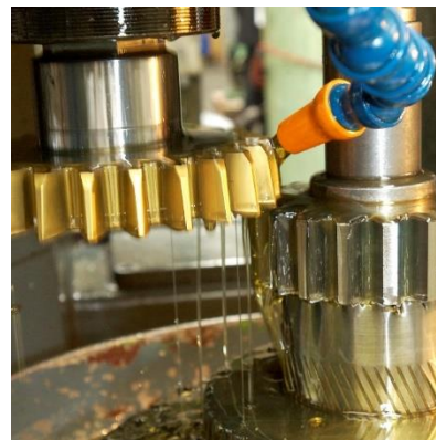
figure 33 : Taillage de pignon cylindrique à l'outil couteau (illustration G. Henriot)
