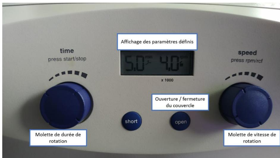
**En cas de vibrations ou de bruit anormal, stopper d'urgence en ramenant le sélecteur de vitesse à zéro. Attendre l'arrêt complet pour soulever le capot**
