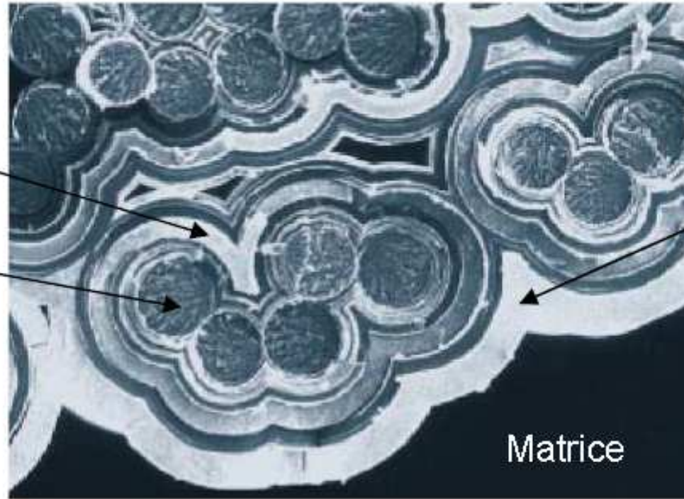
Composite à matrice céramique multicouches auto-curative [EWB]
