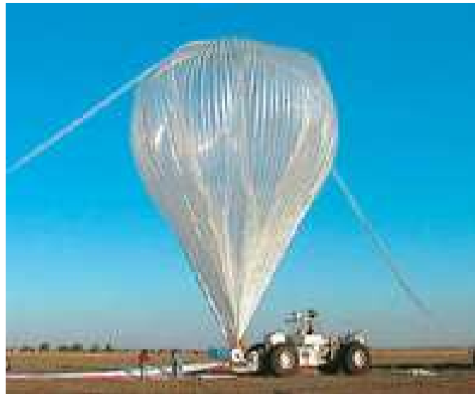
Fig. – Ballon d'observation spatiale dont la voile est réalisée en Zylon ® [NASA]
