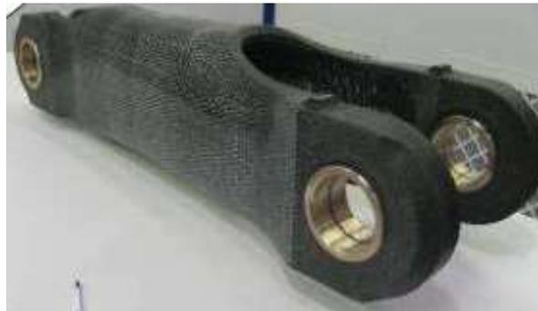
Bielle de train d'atterrissage réalisée en matériau composite
