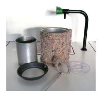
Dans l'expérience décrite ci-dessous, une masse  $m_a$  d'eau de capacité thermique massique  $c_a$  est en équilibre thermique à la température  $T_a$  dans le calorimètre  $(C_c)$ . On y plonge alors un solide métallique de masse  $m_b$  à la température  $T_b$ . On veut déterminer la capacité thermique massique  $c_b$  du métal.
