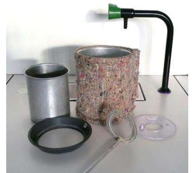
Dans l'expérience décrite ci-dessous, une masse  $m_a$  d'eau de capacité thermique massique  $c_a$  est en équilibre thermique à la température  $T_a$  dans le calorimètre ( $C_c$ ). On y plonge alors un solide métallique de masse  $m_b$  à la température  $T_b$ . On veut déterminer la capacité thermique massique  $c_b$  du métal.
